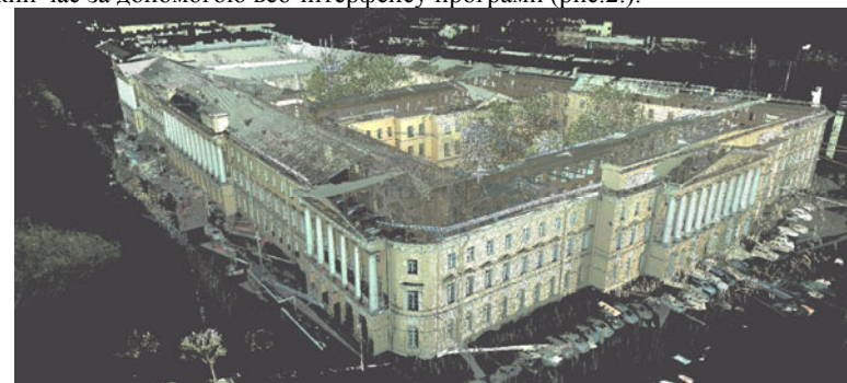
Рис.1. Результат сканування у вигляді хмари точок
