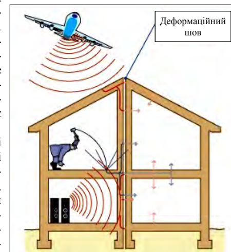
Рис. 3. Деформаційний шов між секціями
