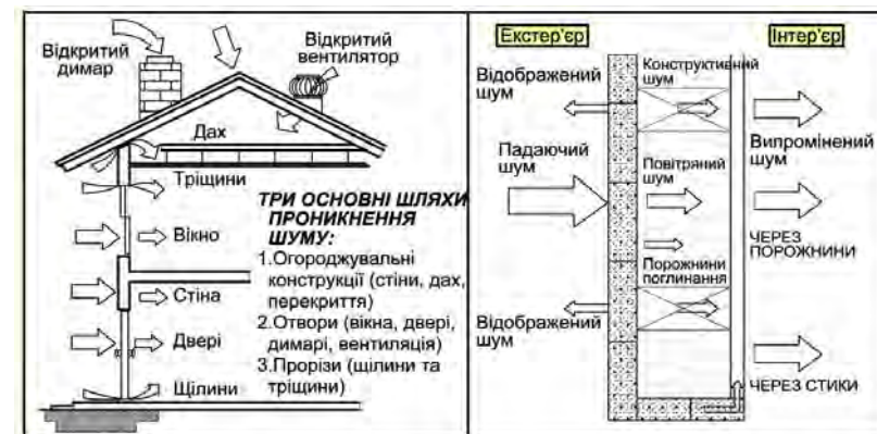
Рис. 1. Основні шляхи проникнення шуму в будівлю
