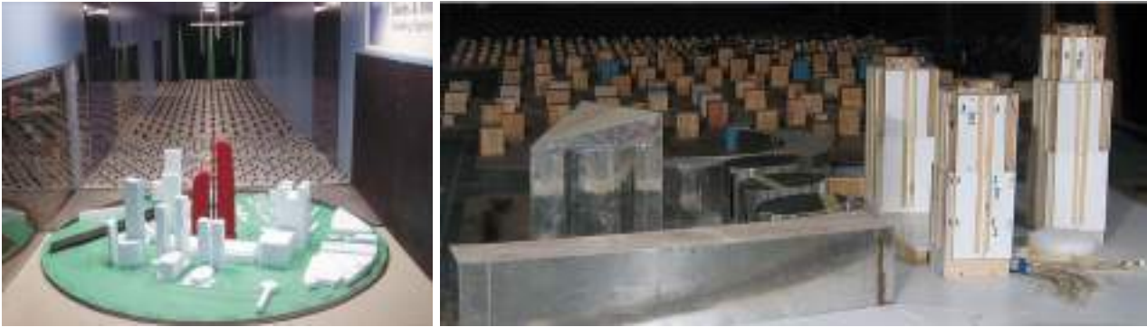
Рис.3. Експериментальні дослідження аеродинамічних характеристик висотних споруд складної геометричної форми
